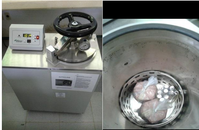
Figura 2. Autoclave, marca: Felisa. Colocación del material que se esteriliza para utilizar en el cultivo.
