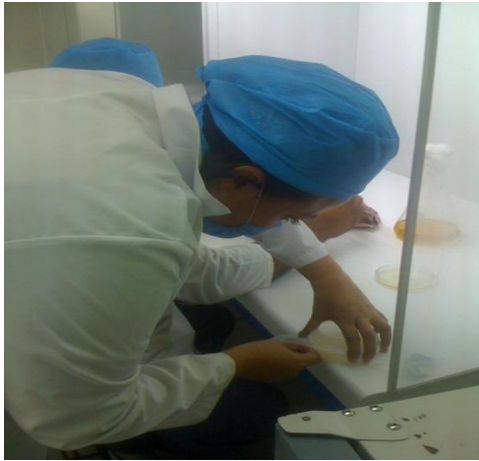
Figura No. 9 sellado de cajas de Petri con cinta parafilm.
