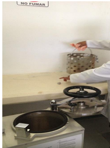
Figura No. 2.- esterilización en autoclave
