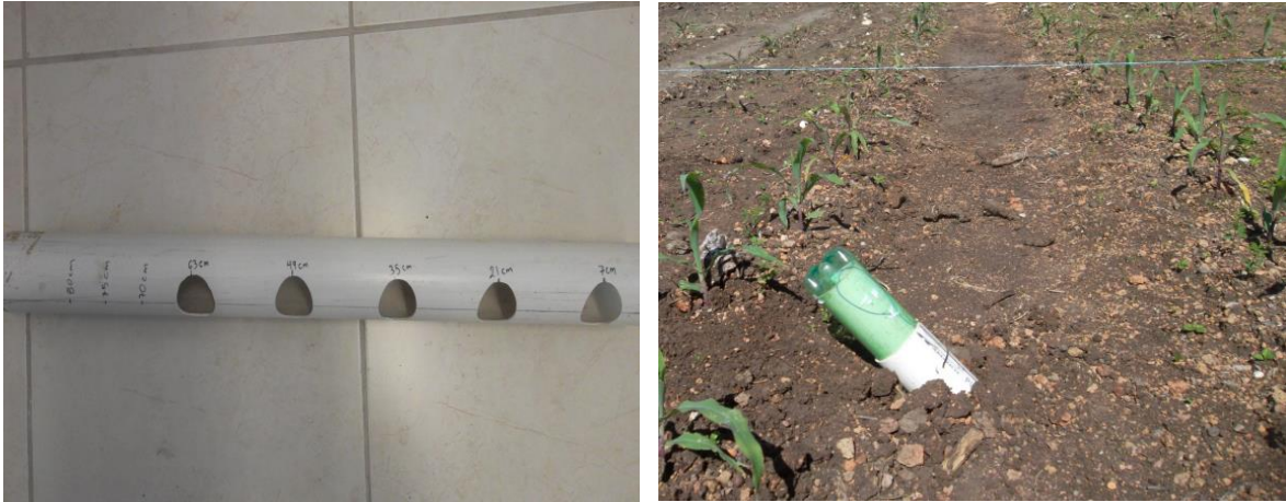
Figura 8. Tubo de mini-rizotrón instalado a angulo de 45°.
