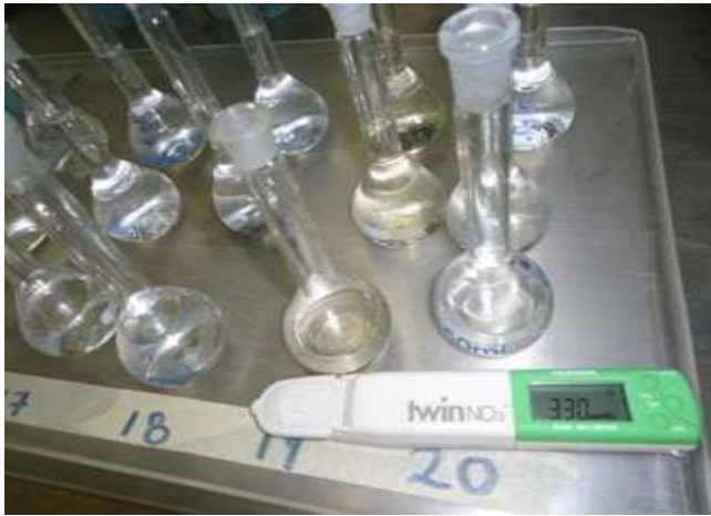
Figura 4. Análisis de las muestras de agua con equipo Twin NO3
