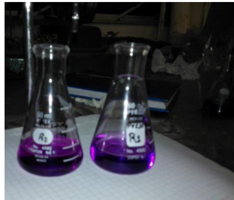
Figura no. 8 titulación con EDTA cambio de vire purpura determinación de Ca
