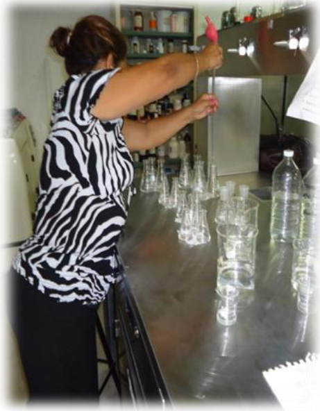
Figura no. 5. Aforando la muestra con agua destilada 13 ml
