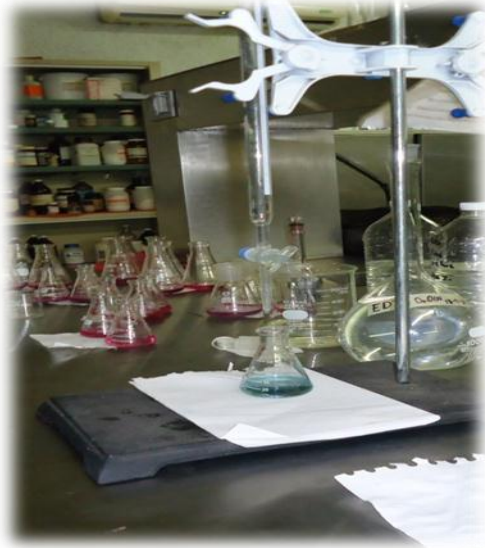
Figura no. 8. Titular con ETDA hasta lograr vire de color rojo a azul determinación de Mg por titulación
