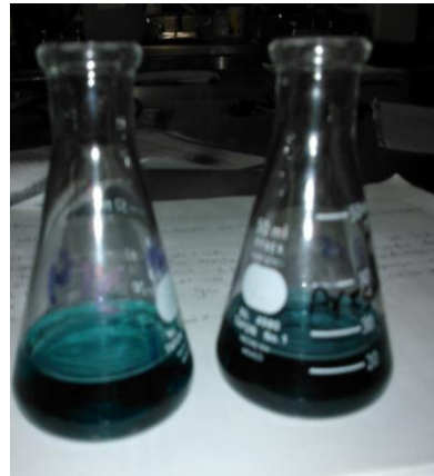
Figura no. 6 Cambio de vire determinación de Mg.
