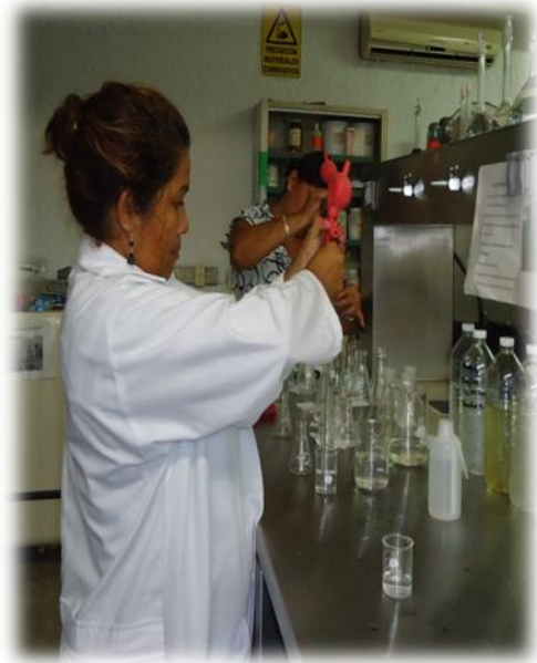
Figura no. 6. Agregando las 10 gotas de solución amortiguadora
