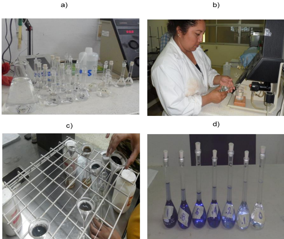
Figura 12. Análisis químicos. a) potasio "K"; b) curva de calibración "K"; c) fósforo "P"; d) curva de calibración "P".
