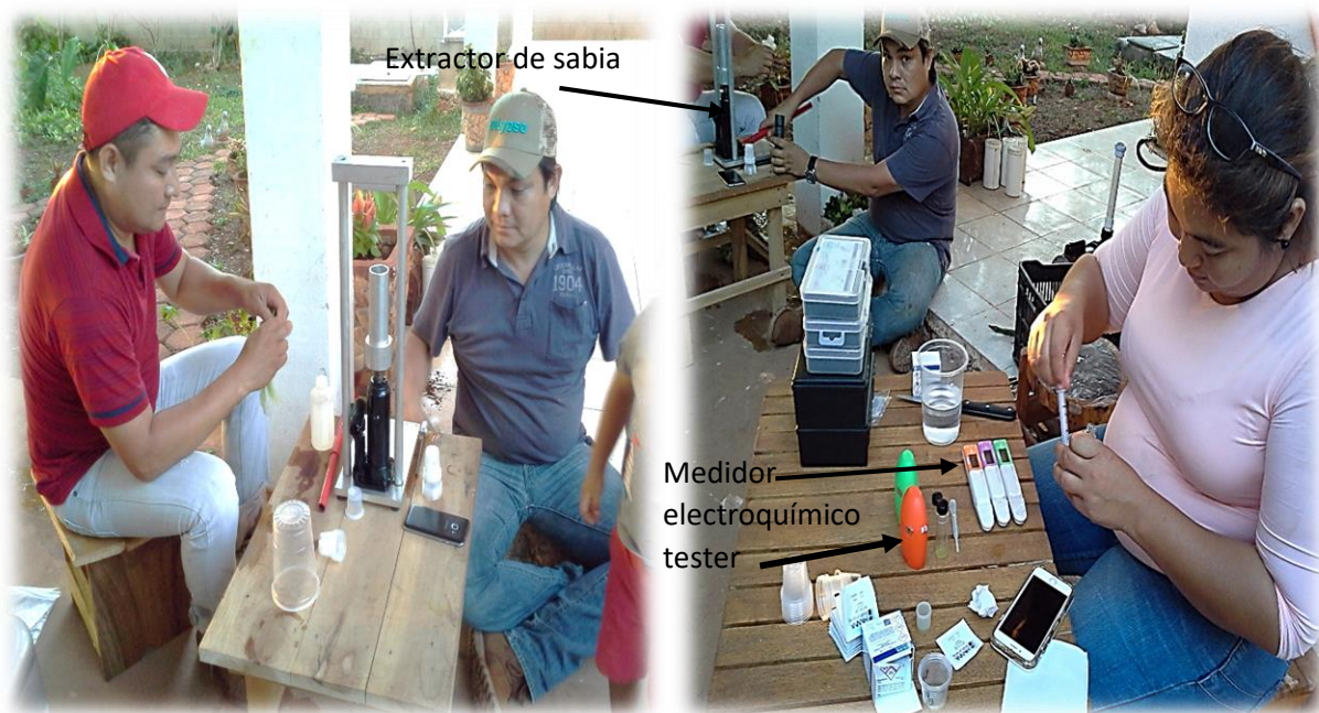
Figura 3. Extractor de savia (imagen izquierda) y lectura de datos en medidor electroquímico (imagen derecha).
