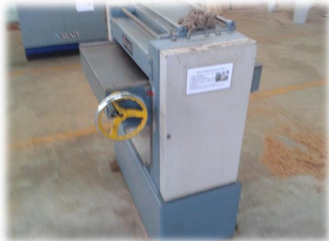
Figura 11. Mantenimiento preventivo (limpieza) aplicado a Cepillo.
