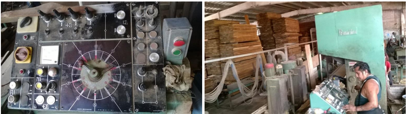
Cuadro 4: panel de control y funcionamiento de la maquina sierra cinta.
