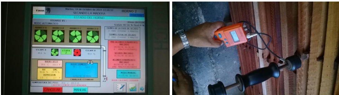
Cuadro 6: control del secado de la madera y manejo del hidrómetro.
