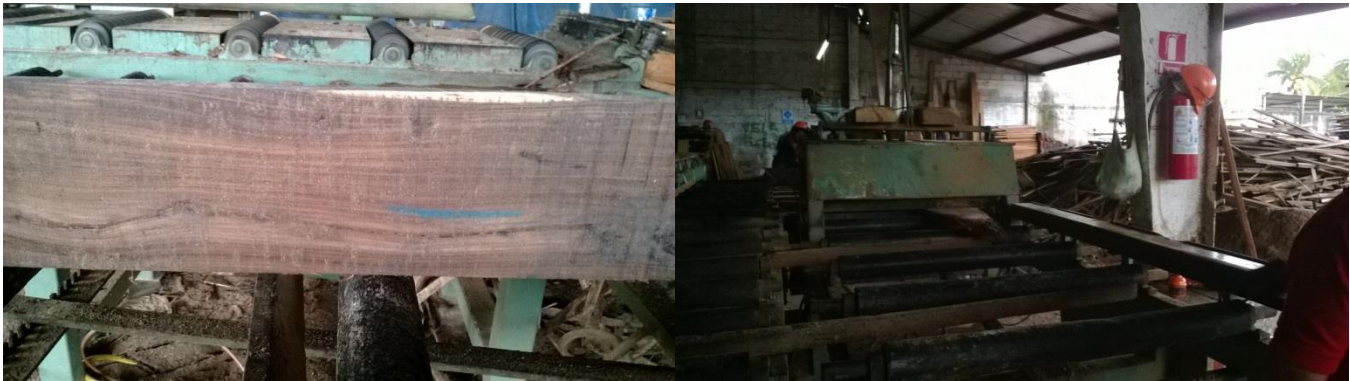
Cuadro 10: desorillado de una tabla aprovechando calidad de madera.
