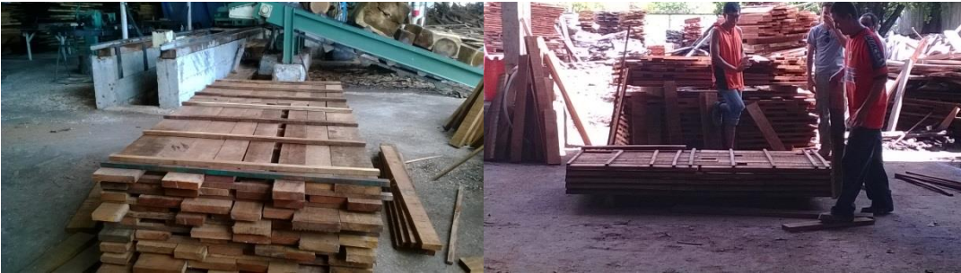
Cuadro 2: separadores de la tablas para la ventila en el secado.
