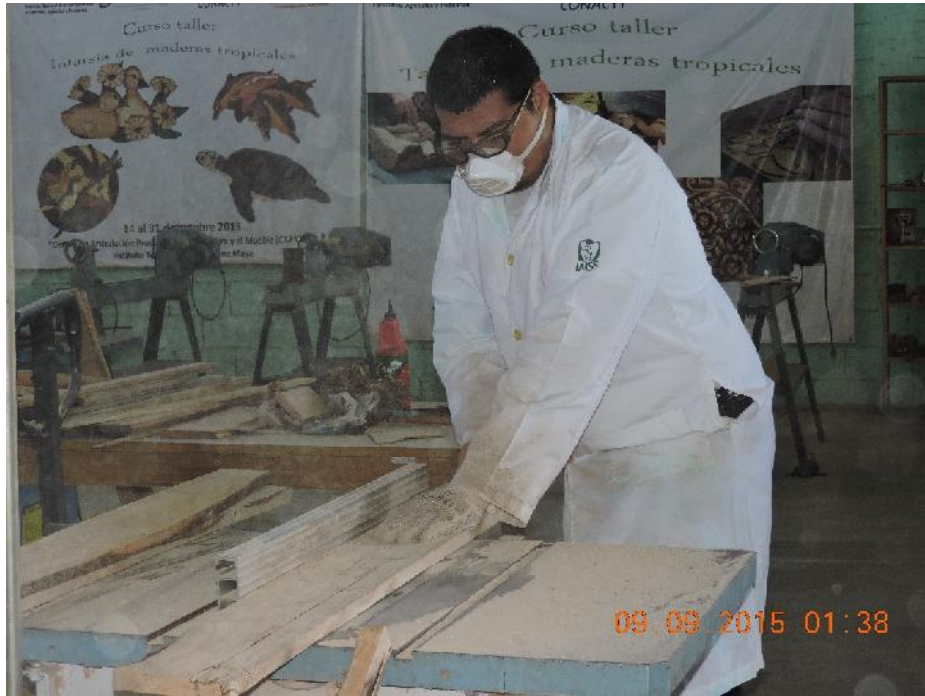
Figura 9. Dimensionado de las piezas de madera a probetas según la norma.
