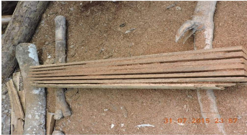
Figura 3. Dimensionado y motoaserrado de los fustes de Kanatzín.
