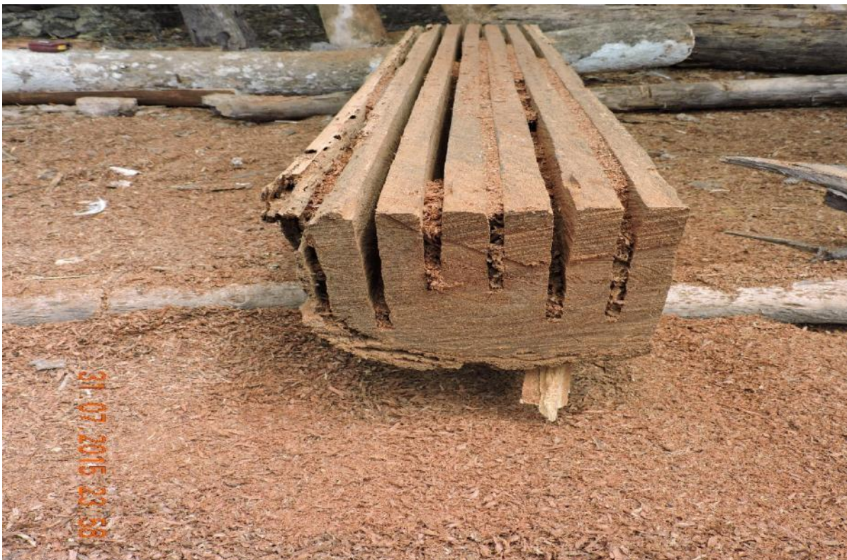
Figura 6. Resultado del Motoaserrado y dimensionado de las piezas de madera
