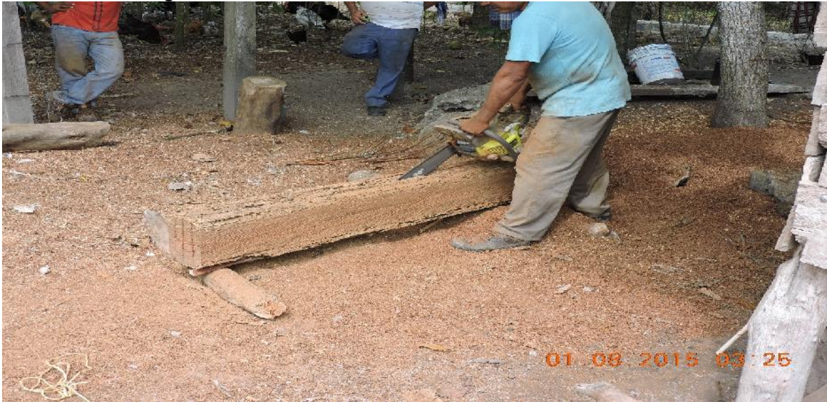
Figura 5. Motoaserrado de fuste seccionado de 1.50 metros.
