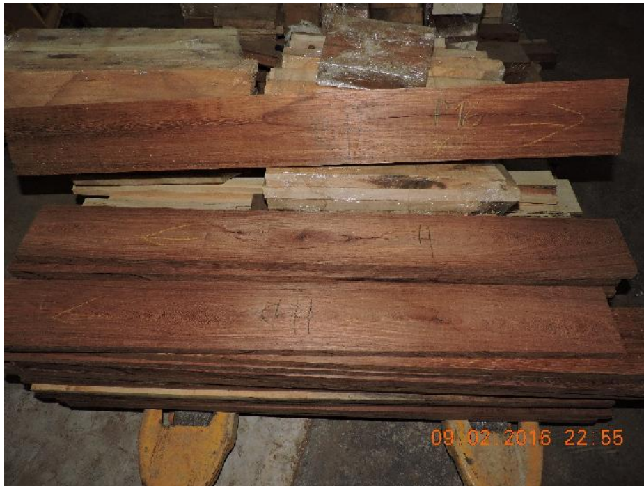
Figura 10. Probetas finales obtenidas tras dimensionar.
