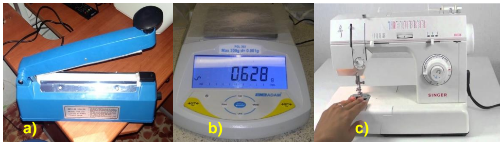
Figura 3. Maquinaria y equipo utilizado para la elaboración de los envases y empaques de té de ramón. a) Selladora térmica de impulso, b) Báscula con capacidad de 5000 g. c) Máquina de coser, puntada normal y bordadora.
