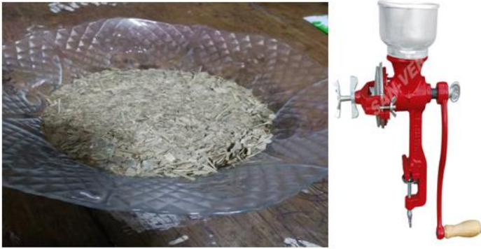
Figura 2. Trituración de hojas con molino casero.
